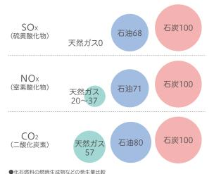
●化石燃料の燃焼生成物などの発生量比較 単位発熱量あたりの発生量を石炭を100とした場合の割合
