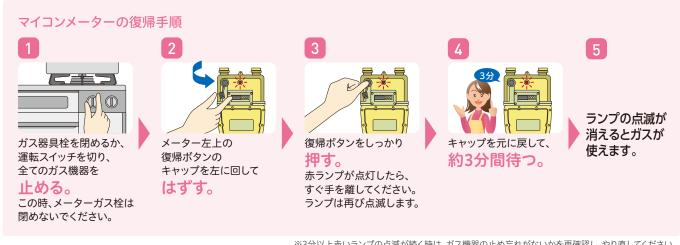
※3分以上赤いランプの点滅が続く時は、ガス機器の止め忘れがないかを再確認し、やり直してください。 正常に復帰しない場合や赤いランプの点滅が続く時は、ガス局へご連絡ください。
